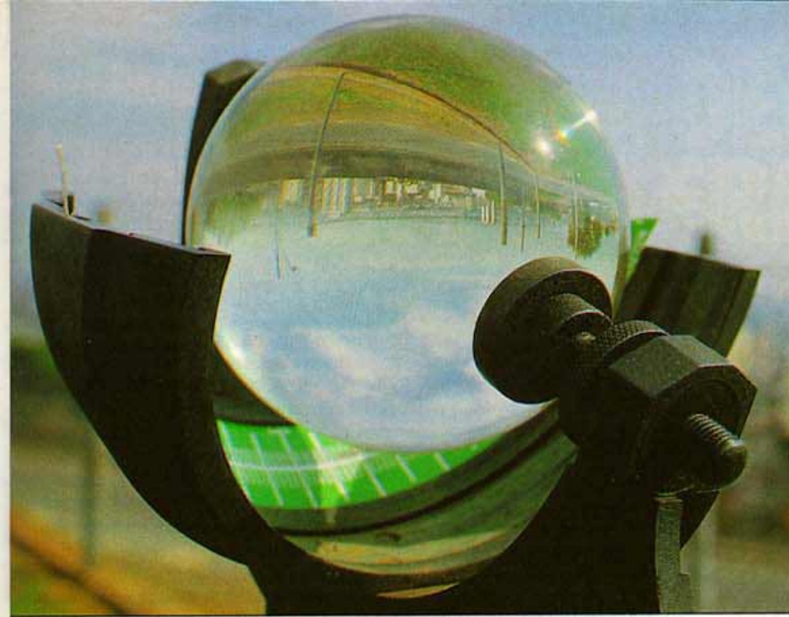
O heliógrafo focaliza os raios do Sol num cartão para medir a luz do dia
